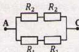
Уитстонов мост) и той може да бъде откачен от веригата. Получава се еквивалентната схема, показана на фигурата по-горе вдясно. [1 т.] Съпротивлението, което ще се измери между точките А и С, е равно на  $R_{AC} = \frac{2R_1 R_2}{R_1 + R_2} = 1,5 \text{ k}\Omega$ . [1 т.]
