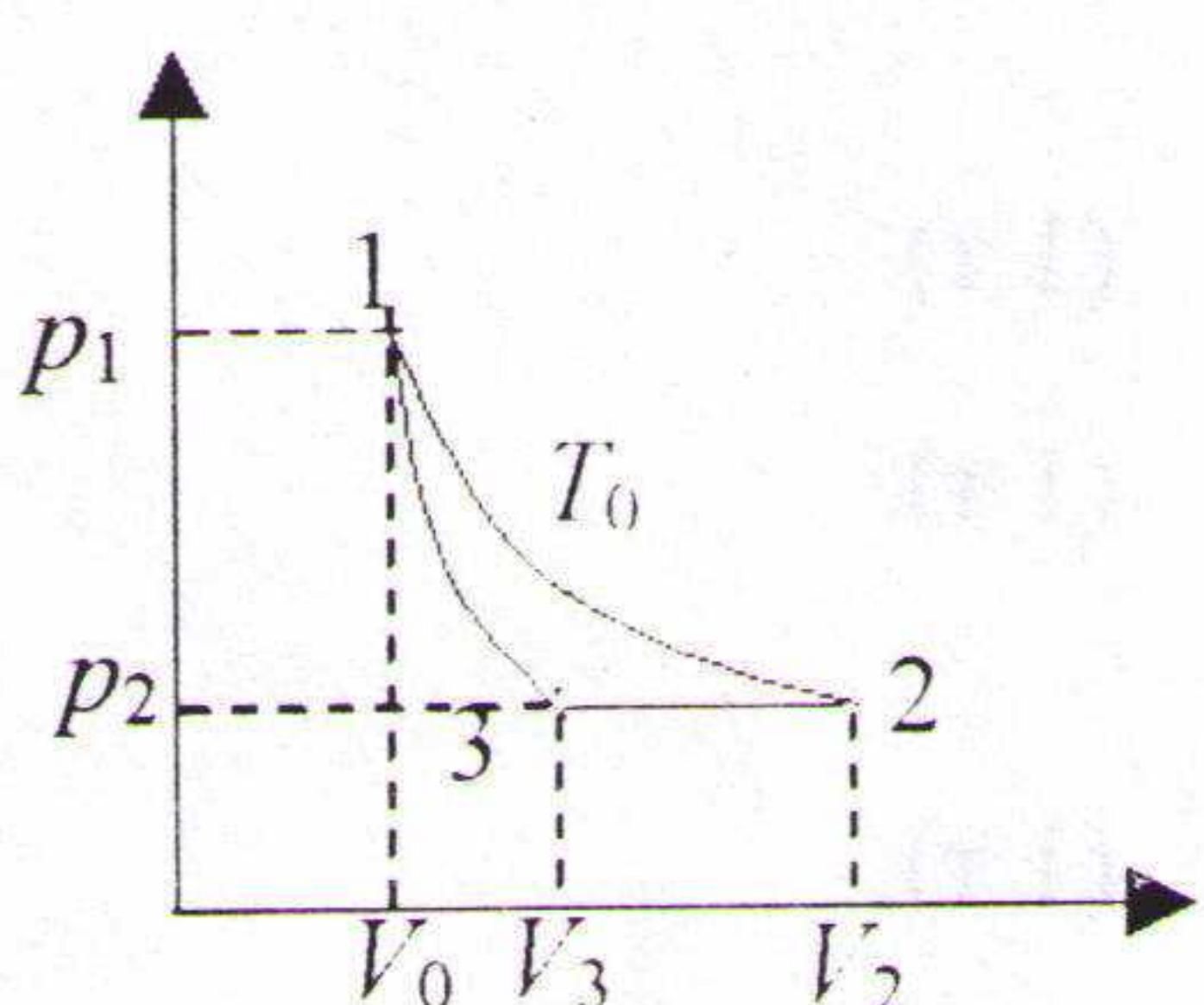
б) Температурата на газа е минимална в състояние 3 (1 т). Процесът 1-2 е изотермен и  $T_2 = T_0$ . За изобарния процес 2-3:
